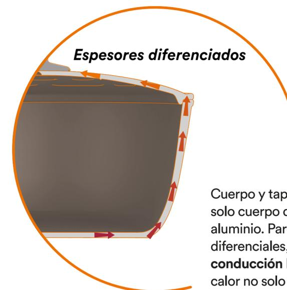
Cuerpo y tapa fundidos en un solo cuerpo de aleación de aluminio. Paredes de espesores diferenciales, favorecen la **conducción** homogénea del calor no solo en el cuerpo sino hacia la tapa.
