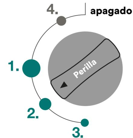
Se muestra una ilustración de una perilla standard de cocinas a gas y la posición de la misma respecto a los fuegos a utilizar. En el caso de contar con el Anafe a inducción (60050179), se muestra en tabla la relación entre fuegos y potencia.
