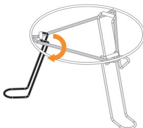
Posición final de las patas a partir del tope mecánico con el triángulo.
